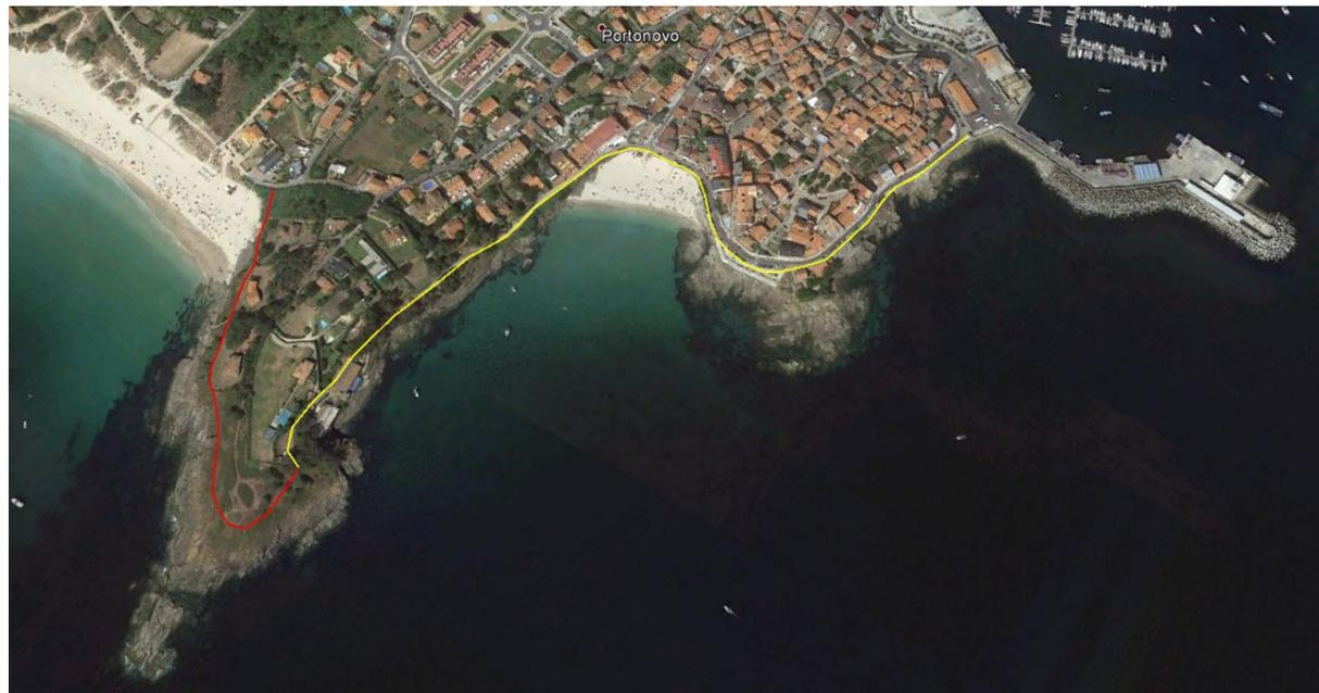
Trazado de la actuación sobre foto aérea, distinguiendo las vías existentes (amarillo) de la nueva senda de madera proyectada en el tramo entre Punta Corveiro y la Playa de Canelas
